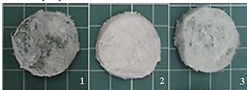
Рис. 7 - Фотографии макропористых матриц на основе сшитого Дж хитозана и его ИПЭК с ГК: 1 – матрикс без ГК-На; 2 – поверхностная модификация ГК-На; 3 – матрикс на основе дисперсии полимеров.
